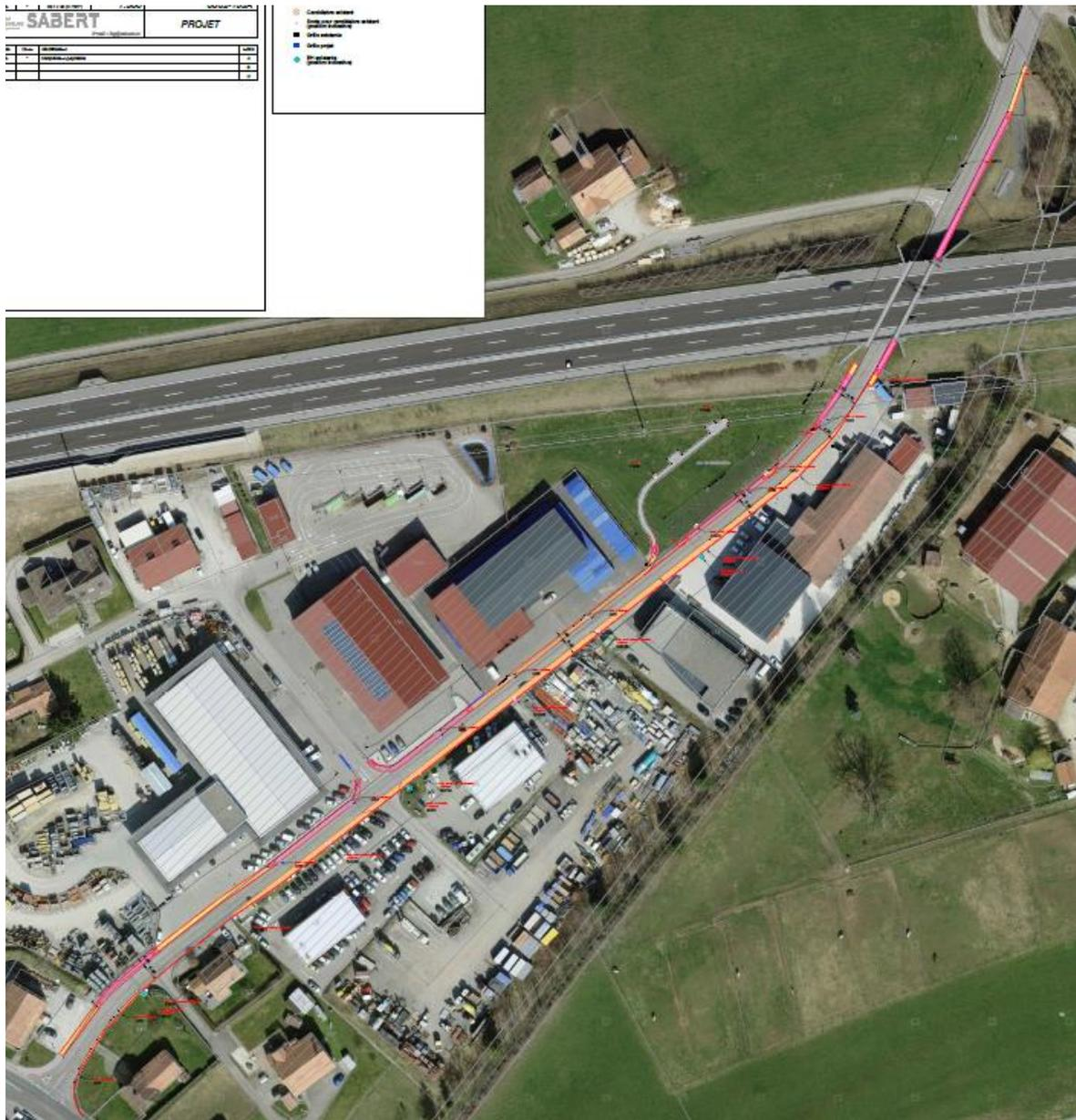
Sur tout le tronçon, le trottoir est équipé d'une bordure haute puis remplacé par un pavé granit pour les différents accès. La largeur de la route va rester à 6 mètres mais son axe sera décalé côté alpes où un nouveau coffre devra être construit dans les limites communales.
