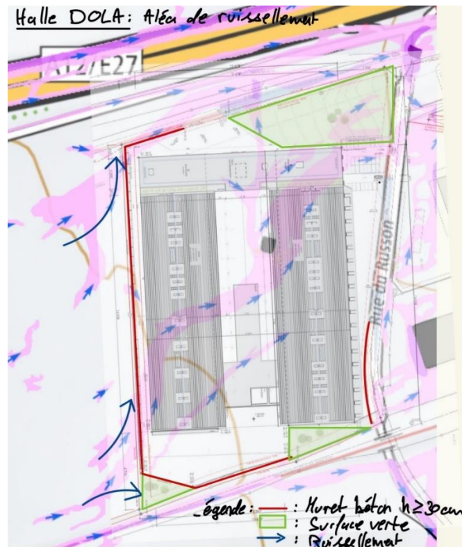
Figure 1 - Aléa de ruissellement et coupure du passage de l'eau
