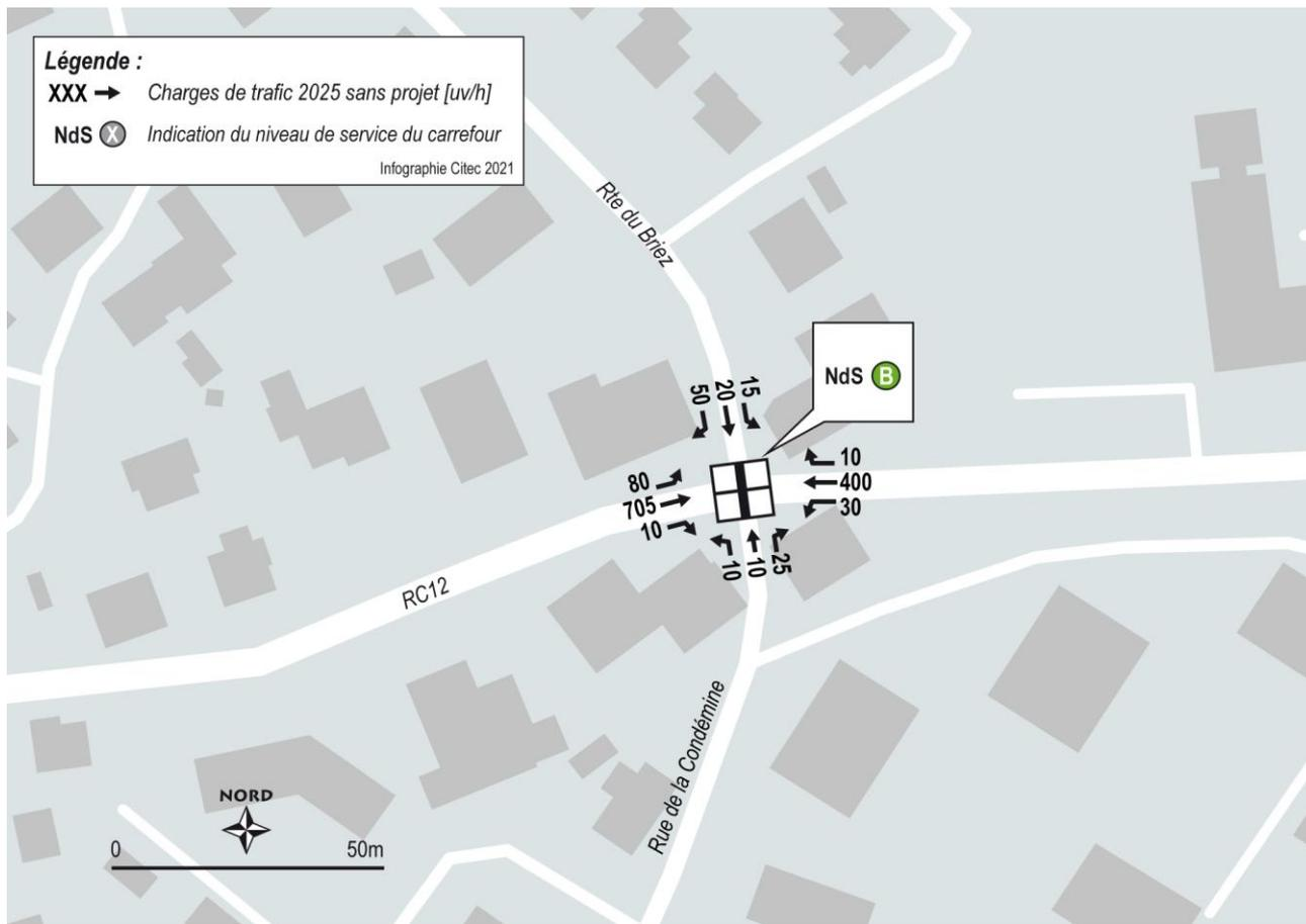
Figure 11 – Charges de trafic estimées HPS pour 2025 au carrefour de la RC 12 et de la route du Briez à Vuadens
